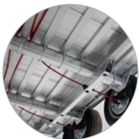
IJzersterke vloerondersteuning door vele kokerprofielen
