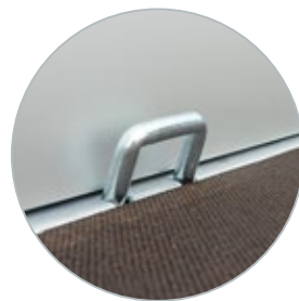
8 bindhaken binnenzijde laadbak
