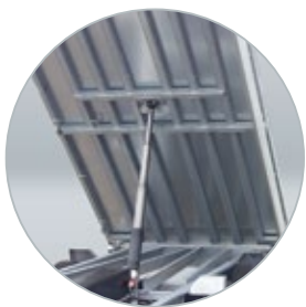
Robuuste vloerondersteuning door kokerprofielen
